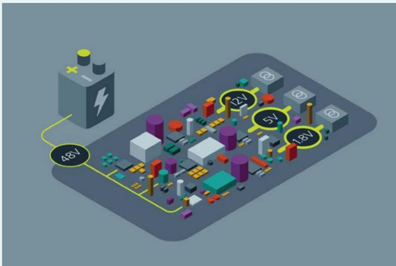
Figure 3 : Les solutions discrètes ont davantage de composants à gérer, ce qui augmente la complexité de la conception.
