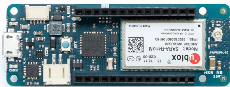
Figure 5 : L'Arduino MKR NB 1500 se connecte aux réseaux cellulaires à bande étroite LTE Cat1 M1/NB1 (Source : Mouser Electronics)
