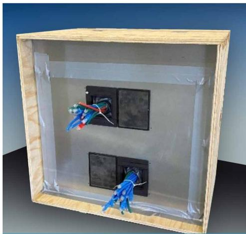
Installation de test pour mesurer les fuites d'air de l'accessoire Joint d'entrée de câble
