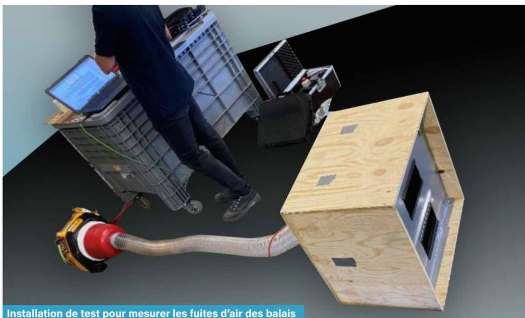
Installation de test pour mesurer les fuites d'air des balais
