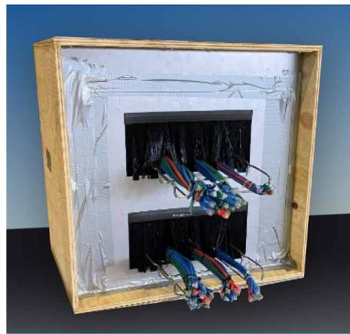
Installation de test pour mesurer les fuites d'air des balais
