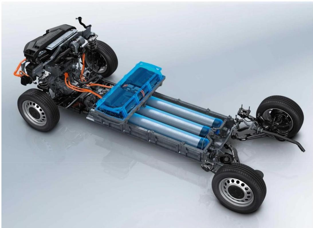
La recharge de la batterie haute tension (10,5 kWh) est opérée via la prise de charge située sur l'aile avant gauche. Le chargeur embarqué triphasé de 11 kW autorise les temps de charge suivants :
