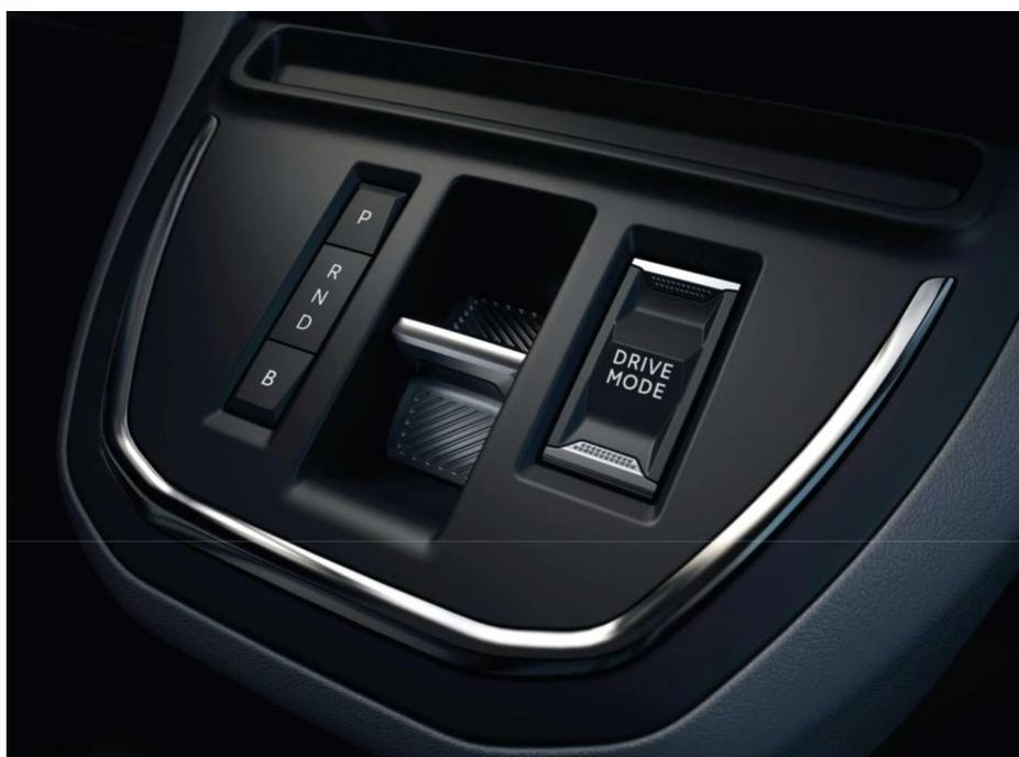
Le nouveau PEUGEOT e-Expert Hydrogen est équipé d'un **frein de stationnement électrique**. En plus de libérer de l'espace au plancher, cette fonction automatique apporte du confort et de la sérénité dans la conduite quotidienne.
