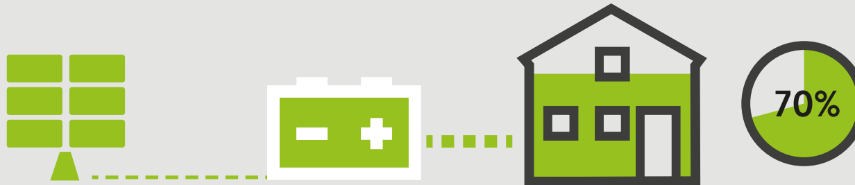
Figure 6 L'utilisation de batteries pour stocker l'énergie produite augmente votre auto-consommation jusqu'à 70%.
