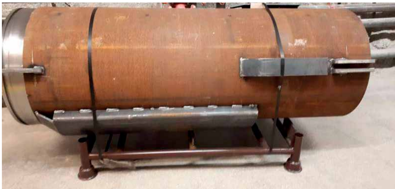
Photographie d'une chemise équipée de centreurs utilisée pour les démonstrateurs d'alvéole de déchets HA réalisés en 2018 dans le Laboratoire souterrain de recherche de Meuse/Haute-Marne
