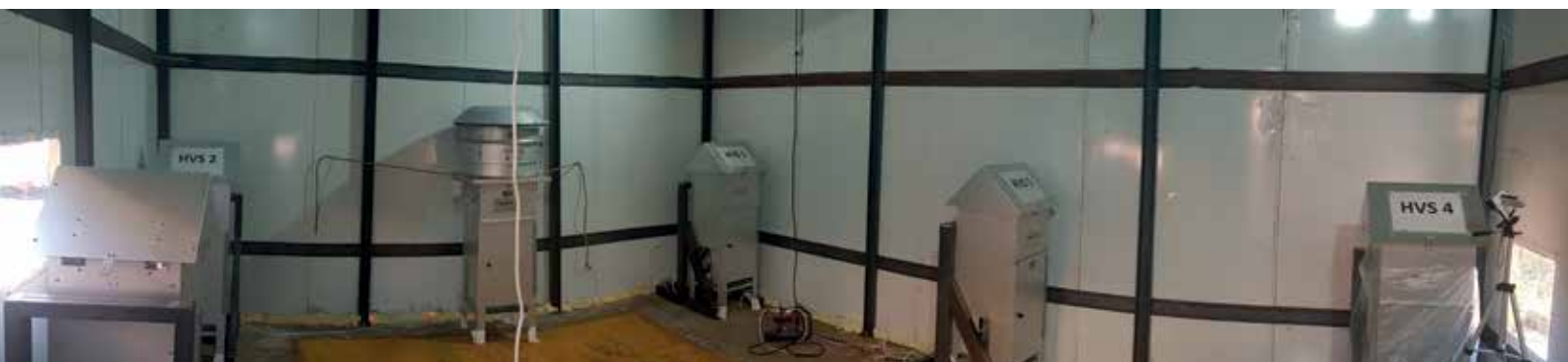
Photographie des positions des préleveurs autour de la dalle dans le cadre de l'essai de chute du démonstrateur CS4.1
