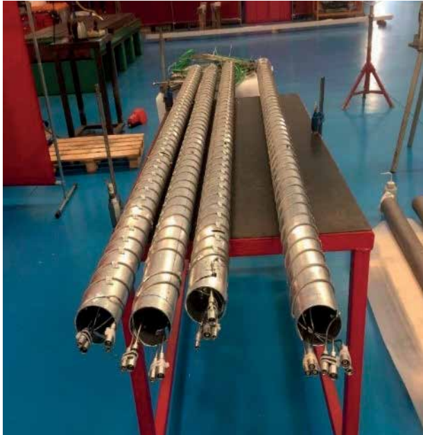
Photographie des sondes chauffantes de l'essai CRQ
