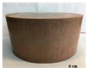
Géopolymère à base d'argilites
