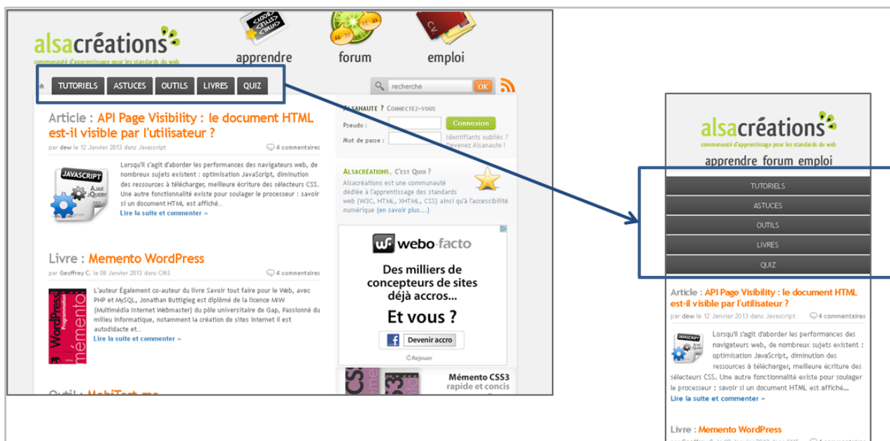
Figure 22 - Pour Alsacreations, les boutons du menu prennent toute la largeur de l'écran sur smartphone - http://alsacreations.com
