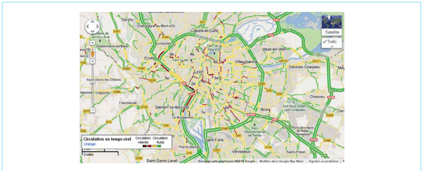
Figure 25 – Trafic sur GoogleMap mesuré par la position et le déplacement des smartphones des utilisateurs
