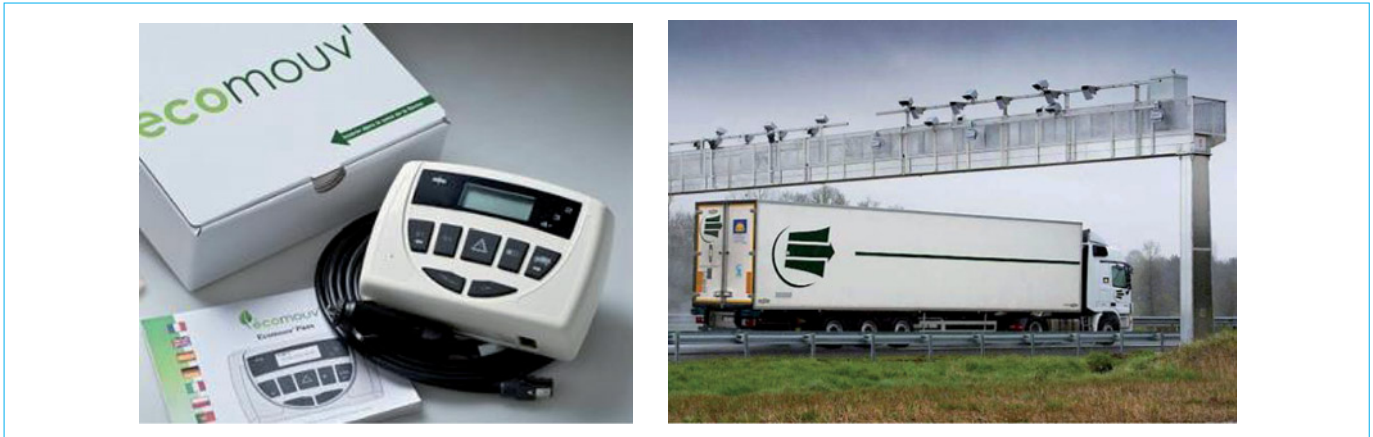
Figure 3 – Équipement embarqué et portique de contrôle du système Ecotaxe
