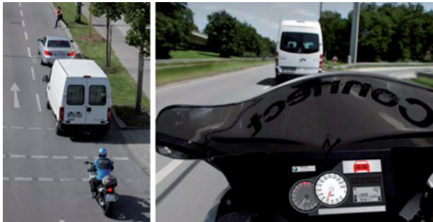
Figure 11 – La moto reçoit une alerte de freinage brusque en provenance de ma voiture placée devant la camionnette (Crédit BMW)
