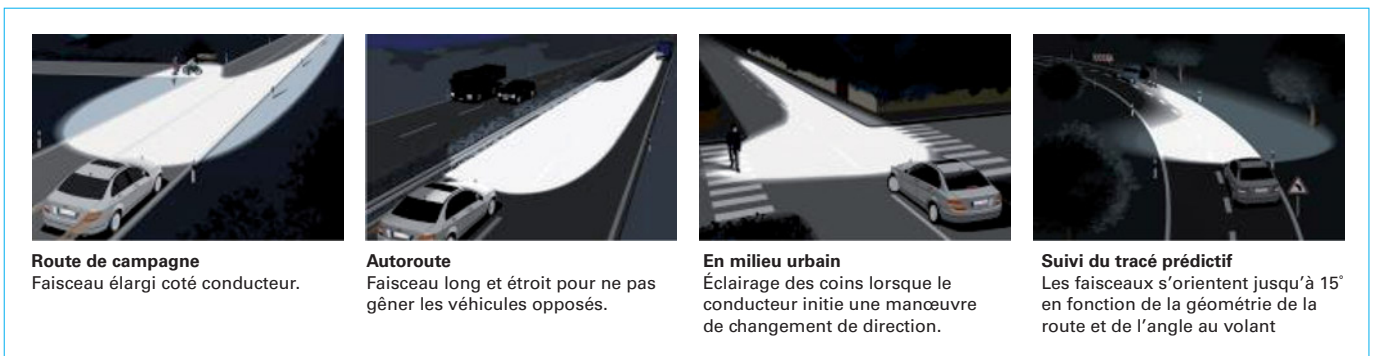
Figure 6 – Exemples de systèmes d'éclairage adaptatifs dans différents environnements (Crédit Daimler Technology & Innovation)
