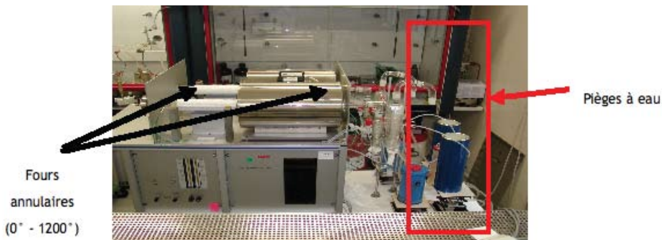
Figure 4.3 - Dispositif de mesure du tritium organiquement lié par combustion dans un four tubulaire (Pyroxydiser).
