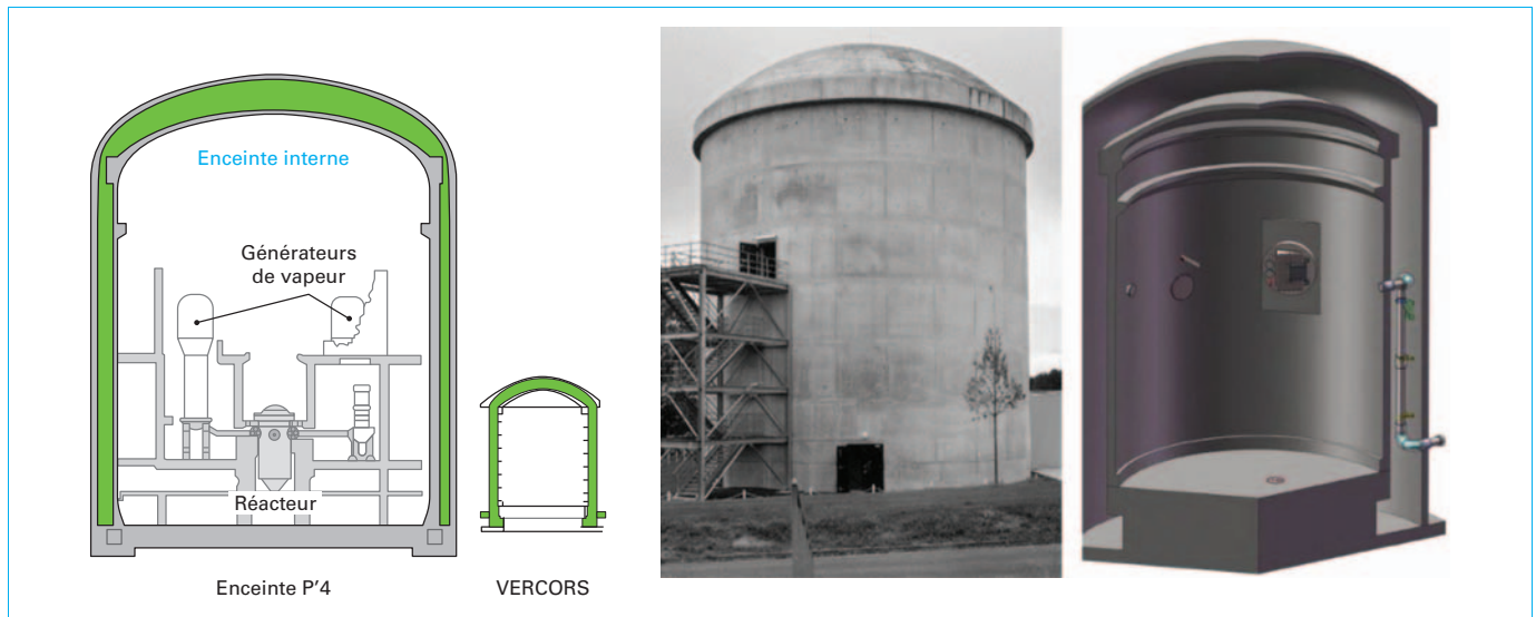
Figure 3 – Photo et représentation schématique de la maquette VERCORS à EDF (EDF Lab Les Renardières)
