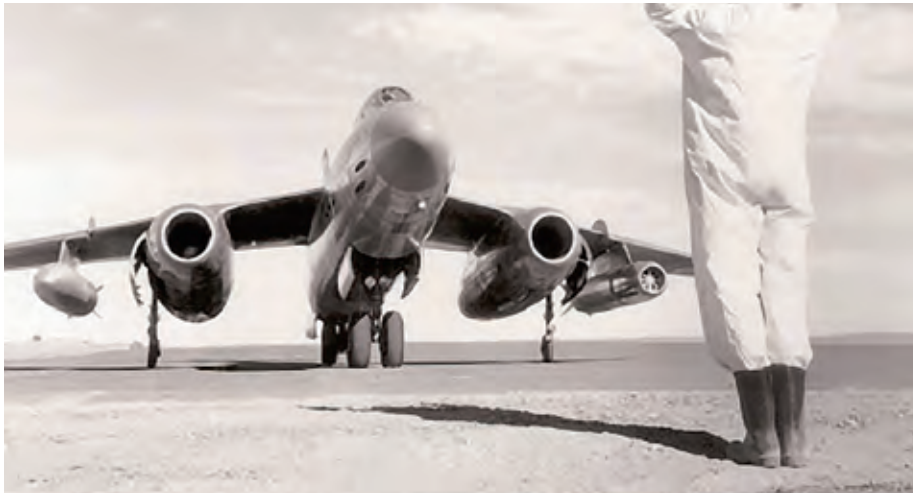
Avion Vautour équipé des systèmes de prélèvement d'échantillons d'aérosols
