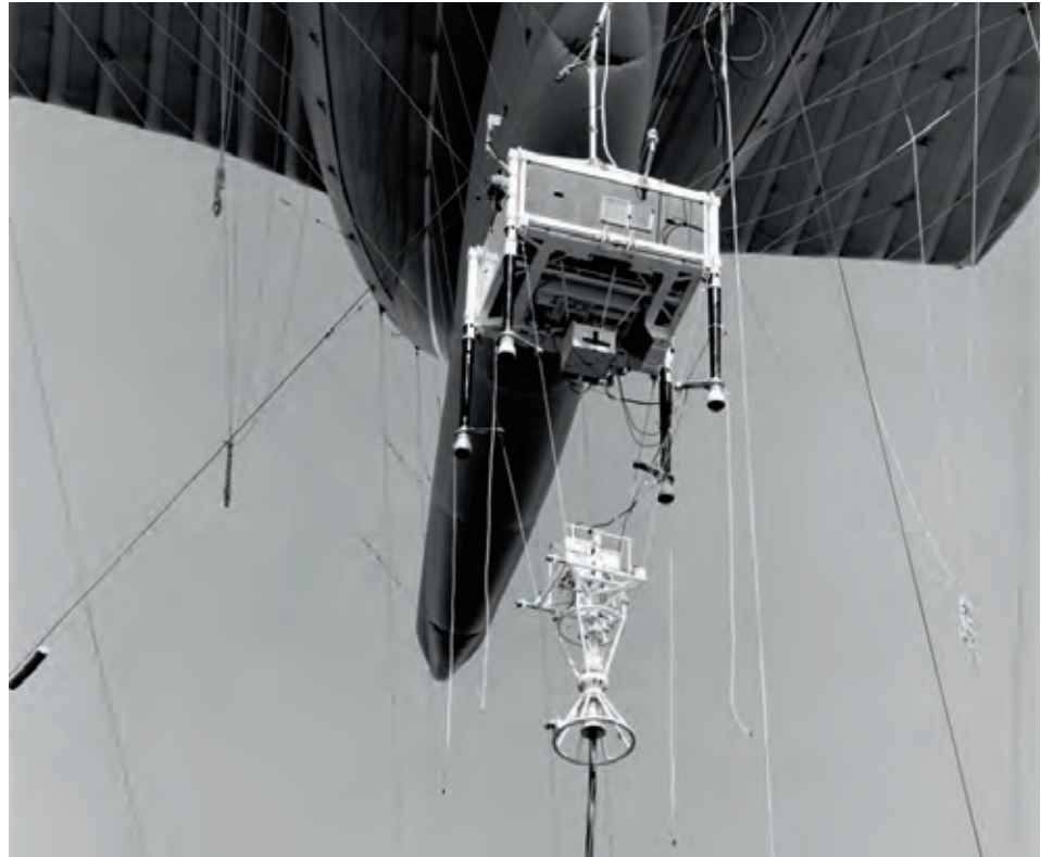
Accrochage des câbles tricoax à la nacelle dans le lagon avant l'essai PHOEBÉ
